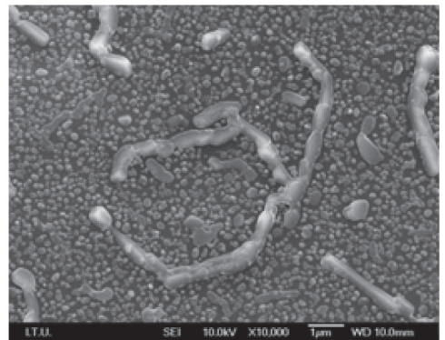
Şekil 4. Yüzeyinde Na 2 SO 4 kristalleri bulunan düzcamın SEM görüntüsü
